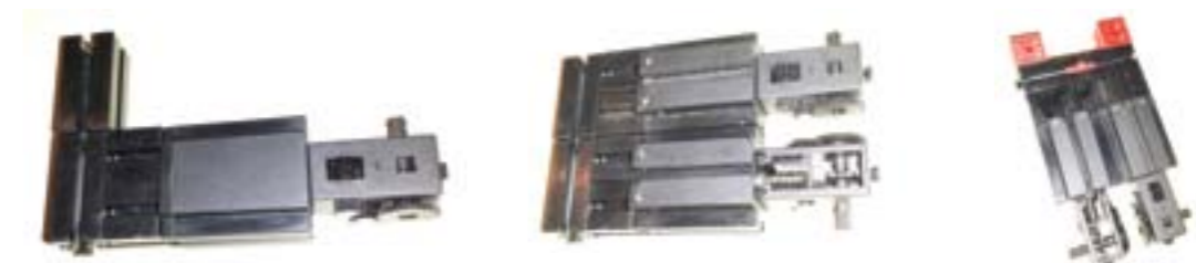
Slika 3.37: Slaganje izgleda robotskih kolica pomoću kockica za spajanje elemenata
