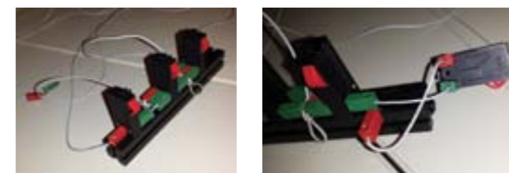
Slika 3.44: Slaganje tipkala za upravljanje robotskim kolicima
