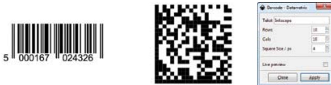
Slika 2.73: Lijevo: linijski barkod, desno dotmatrix barkod
