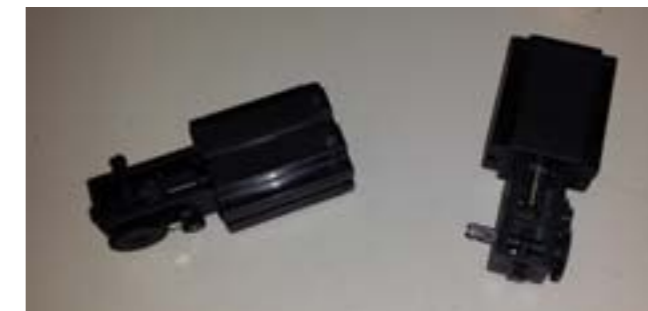
Slika 3.36: Spajanje mjenjačke kutije na motor (2 komada za 2 kotača)
