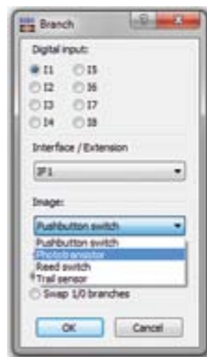
Slika 3.67: Promjena ikone tipkala u fototranzistor u programu RoboPro
