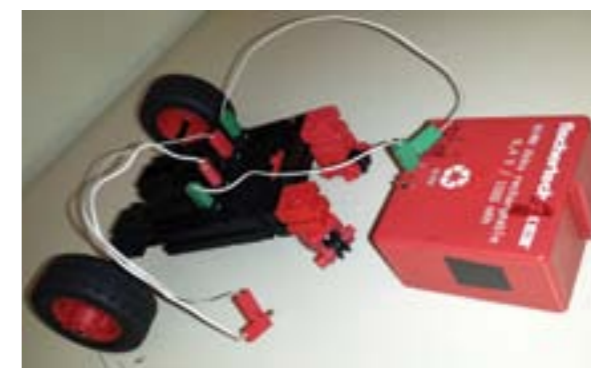
Slika 3.43: Spajanje izvora napajanja na robotska kolica pomoću vodiča
