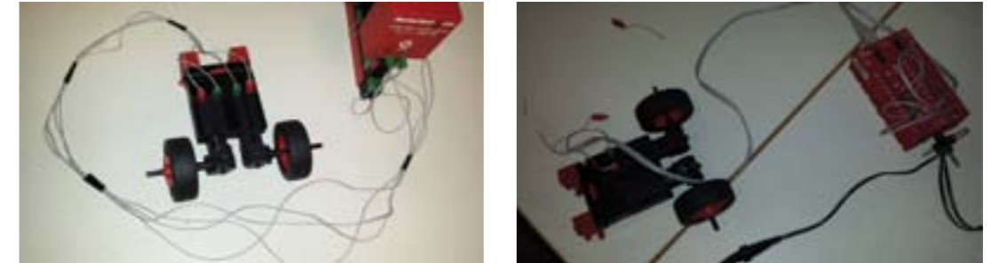
Slika 3.50: Spajanje robotskih kolica na sučelje (za automatsko upravljanje robotskim kolicima pomoću računala)
