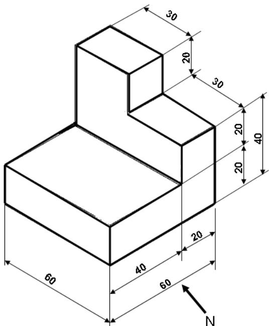
19. **Zadatak:** Temeljem skice u M 1:2 nacrtajte nacrt, tlocr i bokocrt predmeta i kotirajte ga.
